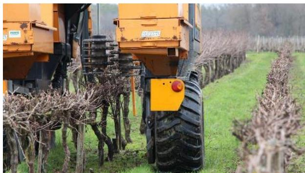
Figure 23 - Taille mécanique de précision d'une vigne.
